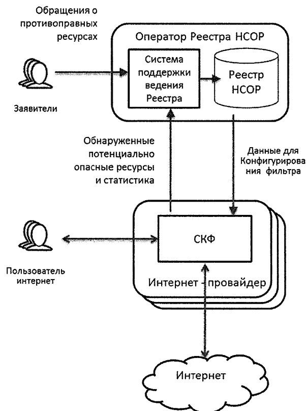
Рисунок 6. Принцип контроля доступа через Реестр НСОР
